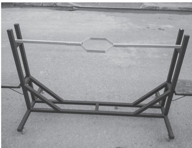
Figura 2. Base giratoria y soporte horizontal.
