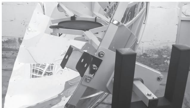
Figura 6. Dispositivo seguidor de sombras.
